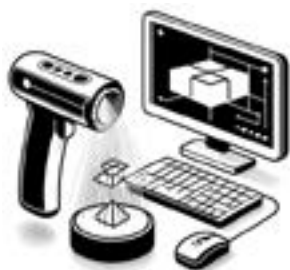
Rokas 3D lāzerskenera darbības princips (autors: J. Heinsbergs)
