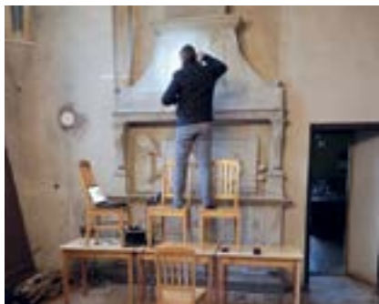
Uzmērīšanas process, izmantojot 3D rokas skeneri (autors: A. Ābele)
