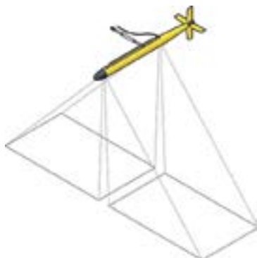
Sānskata sonāra uzmērīšanas princips (Adobe stock)
