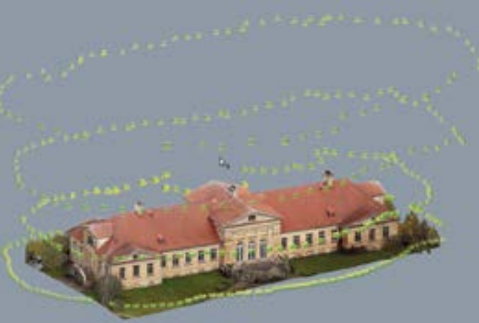
Fotogrāfiju novietojums ap objektu 3D uzmērījuma veidošanai (autors: M. Kaļinka)
