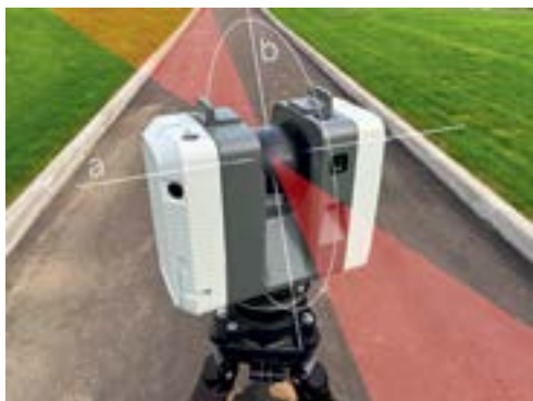
Fiksētās pozīcijas lāzerskenera rotācijas ap savu asi uzmērīšanas laikā (Adobe stock)
